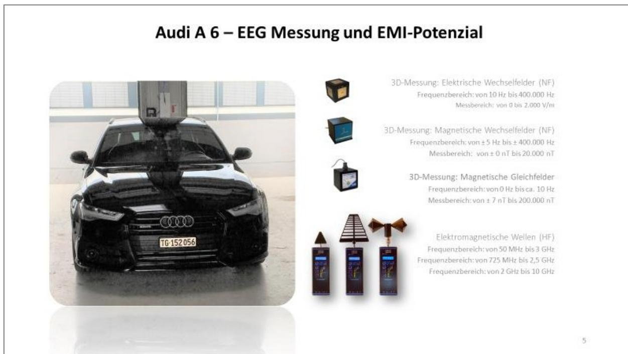
Mesure dans un véhicule non blindé : pré-test sans exposition aux rayonnements, uniquement moteur, moteur+ climatisation, moteur
